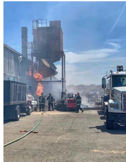
Fig.1. Explosión en filtro de mangas
