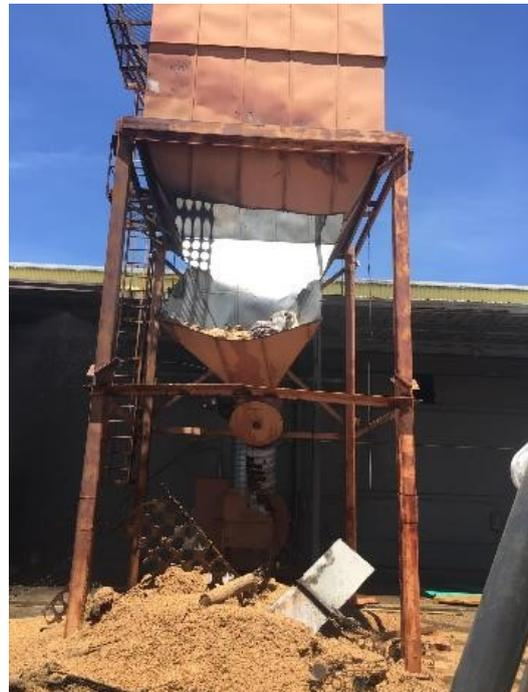
Abb.. 1. Muffenfilter nach einer Explosion
